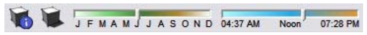
Shadow Toolbar = Công cụ giả lập bóng đổ Hộp thoại bóng / Tắt bật bóng / Tháng trong năm / Giờ trong ngày
